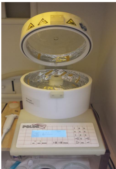
Obrázek P10a a P10b: Obr. P10a: Spin coater, Obr. P10b: Rotační část spin coateru s upevněným substrátem
