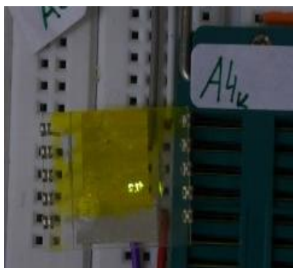
Obrázek 22: Svítící OLED při hodnotách 15V a 48 mA (vzorek 27 A6)
