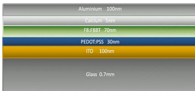
Obrázek 17: Zobrazení ideálních tlouštěk vrstev při námi zvoleném výrobním postupu (F8BT 70nm > 80nm)
