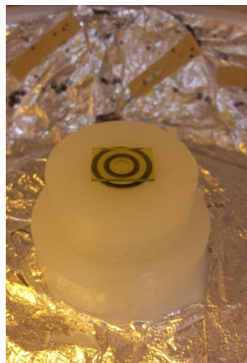
Obrázek P10a a P10b: Obr. P10a: Spin coater, Obr. P10b: Rotační část spin coateru s upevněným substrátem
