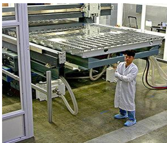
Obrázek 11: Ukázka reálné inkoustové tiskárny pro tisk OLED
